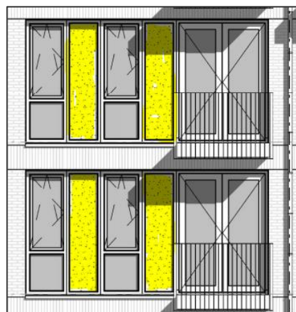
Figuur 6b Locatie panelen, zuidoostgevel woningtype C
